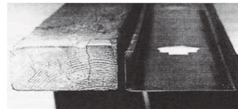
Foto 2.2 - Perfis estruturais de madeira e aço galvanizado (Fonte: Robert Schaff)
