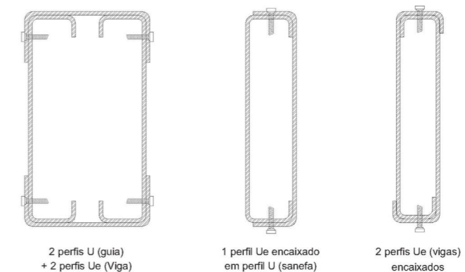
Figura 4.11 - Vigas compostas para aumentar a resistência
